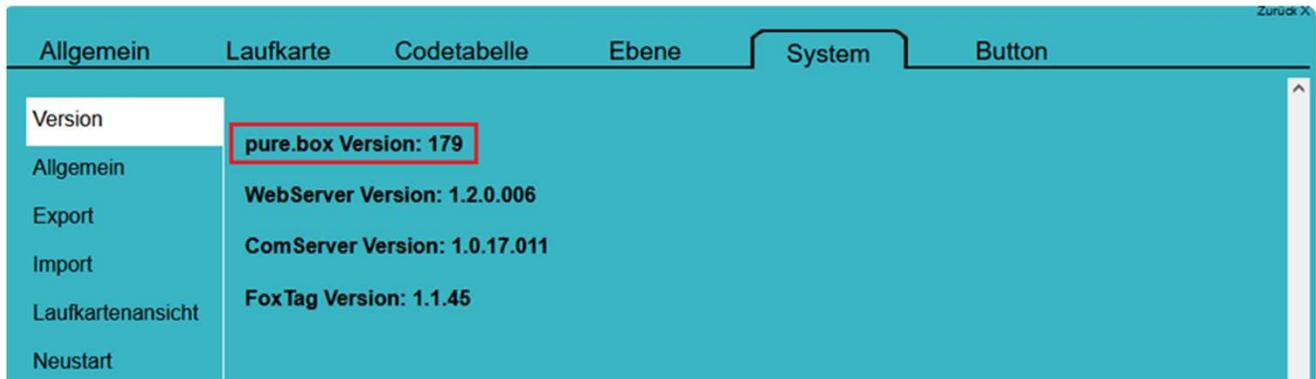
Sollte die pure.box Version kleiner als 160 sein, muss zuerst ein Firmware-Update an der Box durchgeführt werden.
