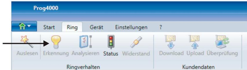
Die einzelnen Komponenten und Verbindungen (Topologie) werden ermittelt und angezeigt.
