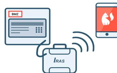
Für die Nutzung der FOXTAG-Applikation ist ein separater Zugang mit der FOXTAG GmbH zu vereinbaren. Die Verbindung zwischen IRAS und FOXTAG stellt sicher, dass die Daten der Melderprüfungen und Prüfung von Steuerungen automatisch in die FOXTAG-Dokumentation übernommen werden und damit eine manipulationsarme Prüfliste dem Betreiber zur Verfügung gestellt werden kann. Die Digitalisierung der Prüfung unterstützt die Ein-Mann-Wartung!
