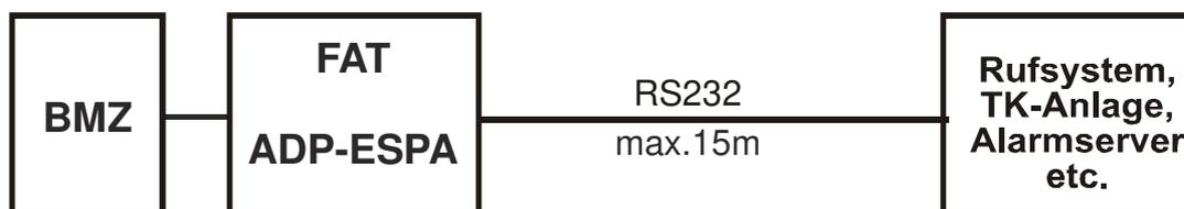
Abbildung 2: Kopplung über RS232 ohne galvanische Trennung
